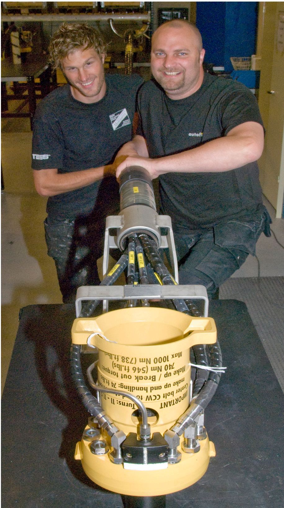
Hydraulic Flying Leads: Formann Kristian Cappelen (t.v.) og montør Borgar Koppangen ferdigstiller en komplett enhet for direkte installasjon mellom moduler på sjøbunnen.
